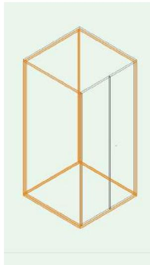
03-底板から側板2面に、側板2側から背板にビスで固定
